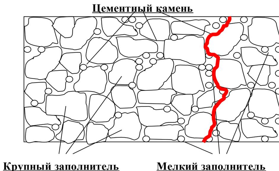
Рисунок 2 – Схема разрушения бетона по зоне контакта зерна заполнителя и цементного камня
