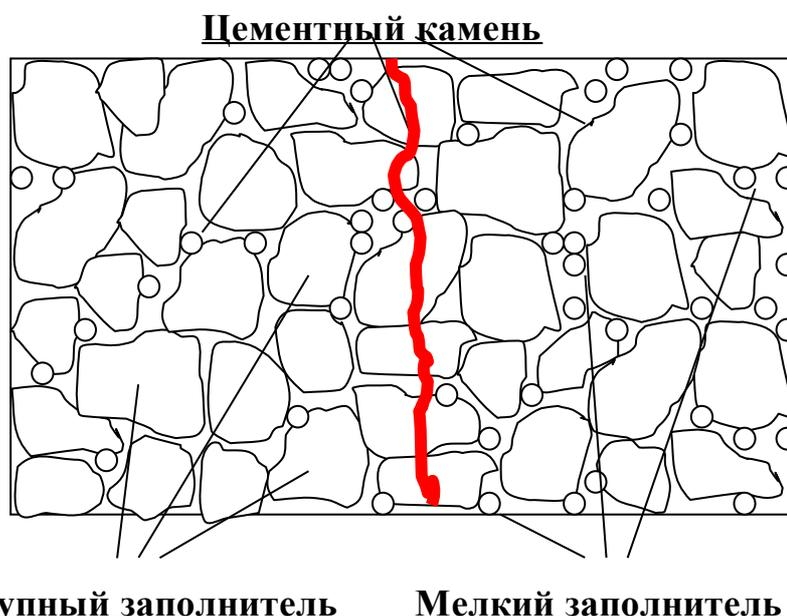
Рисунок 1 – Схема разрушения бетона по зерну заполнителя
