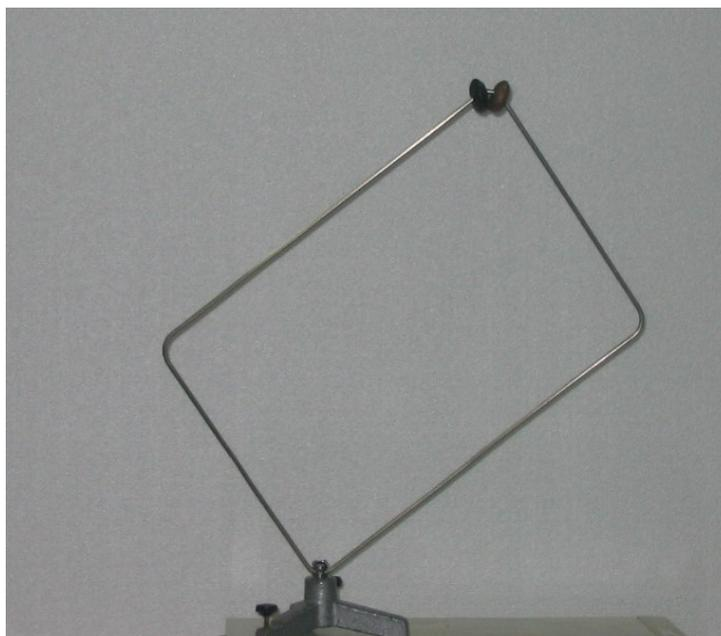
Методические указания: устройство, используемое в задаче, изготавливается из стальной проволоки, диаметром 1–2 мм и длиной 1,0 – 1,2 м. Перед тем как спаять концы проволоки на нее нанизывают две просверленных заранее шайбы или бусинки.
