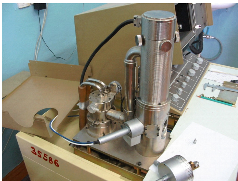
Рисунок 1. Растровый электронный микроскоп JSM-T20.
