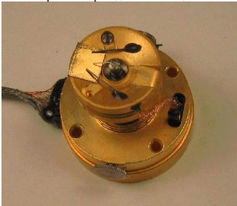
Рисунок 2. Миниатюрный сканирующий туннельный микроскоп.
