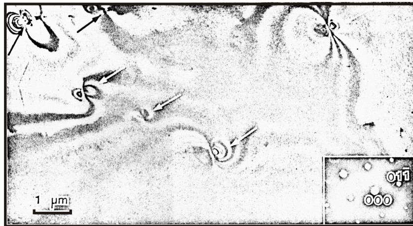
Рис.1 – Типо – размерная схема металл – водородных кластеров – источников хрупкого разрушения структур стали. Экпериментальные данные представлены в таблице; d – период кристаллической решетки феррита.
