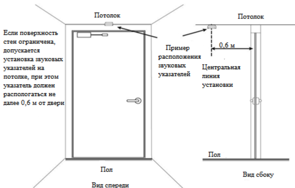
Рисунок 3 - Установка звуковых указателей на потолке
