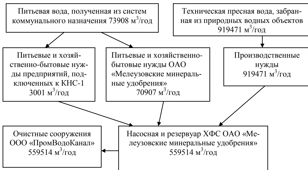
Рисунок 1 – Балансовая схема потребления воды
