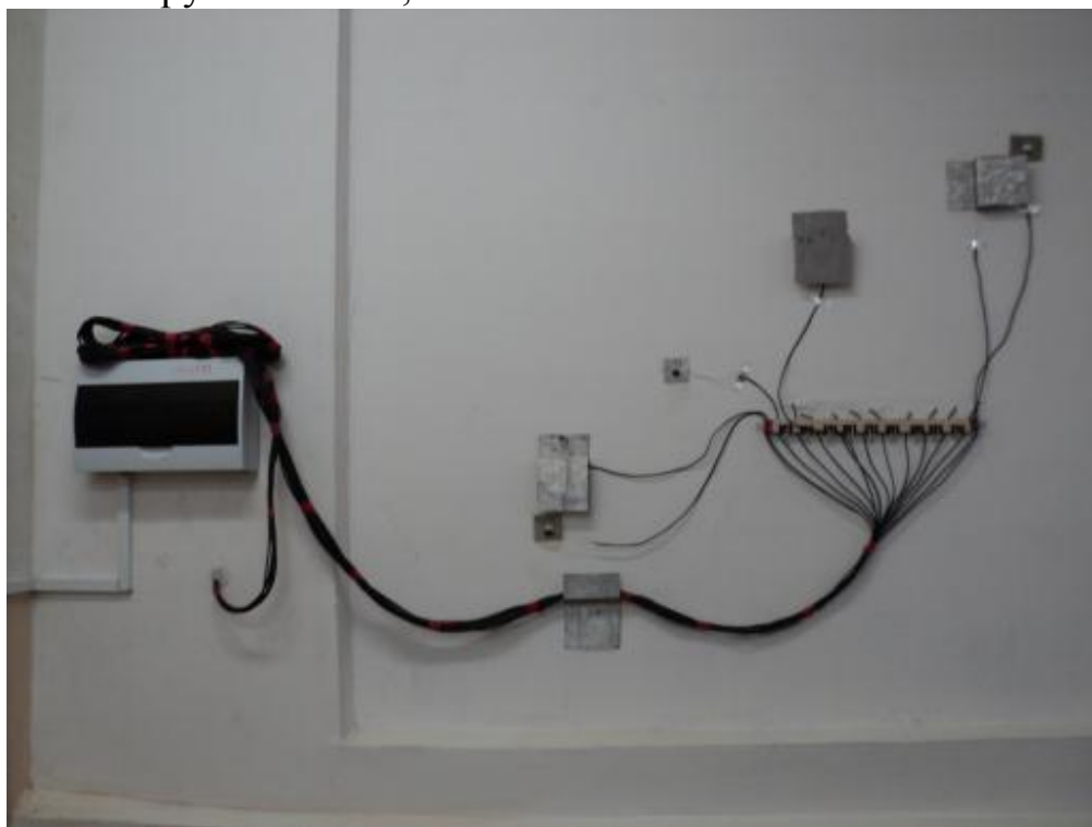
Рисунок 1 – Общий вид стенда для изучения процессов тепло – и массообмена в многослойной наружной стене
