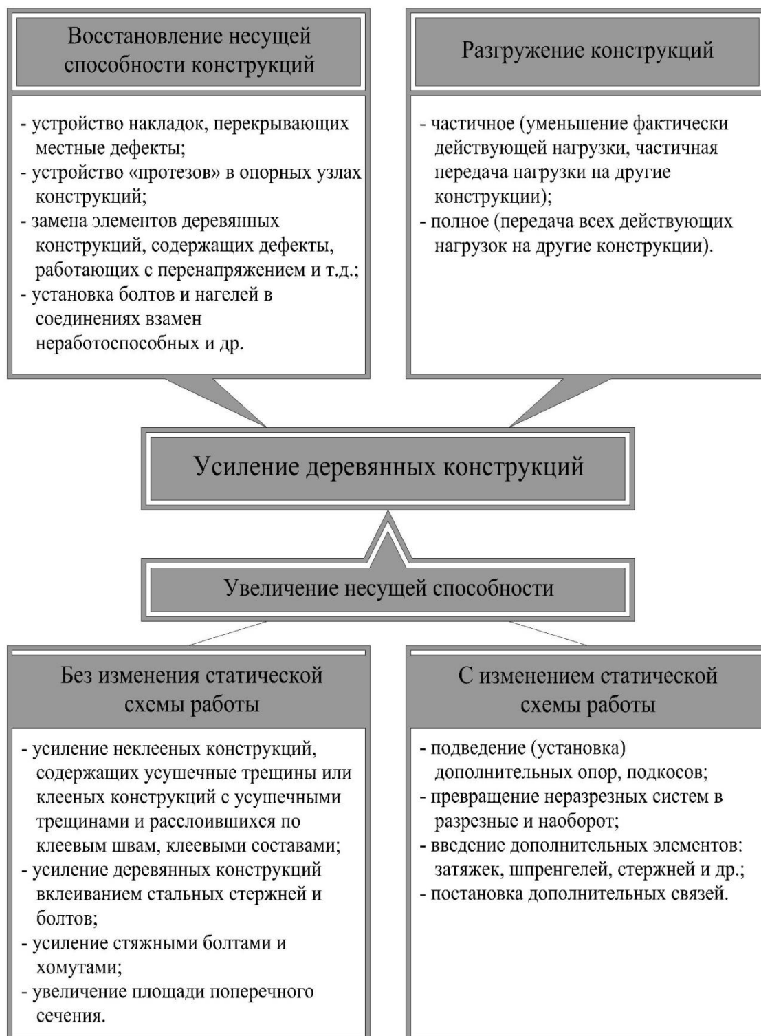
Рисунок 1 - Способы усиления деревянных конструкций
