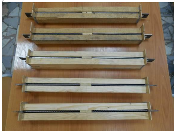
Рисунок 6 – Образцы для испытаний на растяжение, подготовленные для заливки клеем (а) и общий вид испытательной установки (б)
