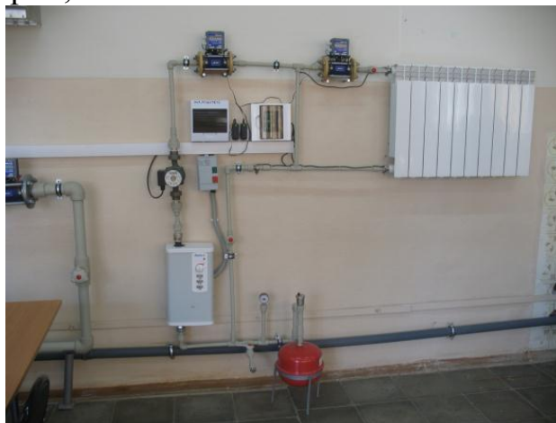
Рисунок 7 – Лабораторный стенд для изучения тепловых характеристик отопительных приборов
