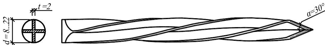
Рисунок 4 - Стальной крестообразный стержень витой формы
