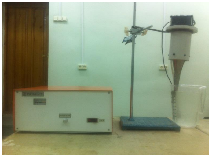
Рисунок 1 – лабораторный ультразвуковой диспергатор УЗД 2-0.1/22
