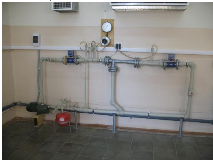
Рисунок 6 – Лабораторный стенд для изучения работы водоструйного элеватора в составе системы отопления
