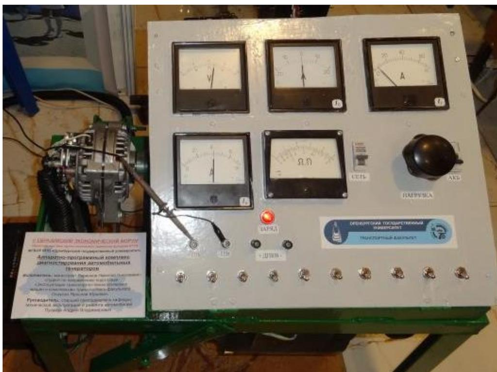
Рис. 5 – Фото аппаратно-программного комплекса диагностирования автомобильных генераторов
