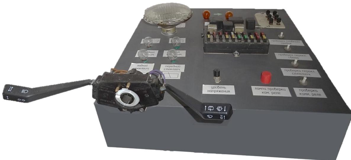
Рис. 1 – Лабораторный стенд «Защитная и коммутационная аппаратура автомобиля (ЗКА-ТЭРА)»
