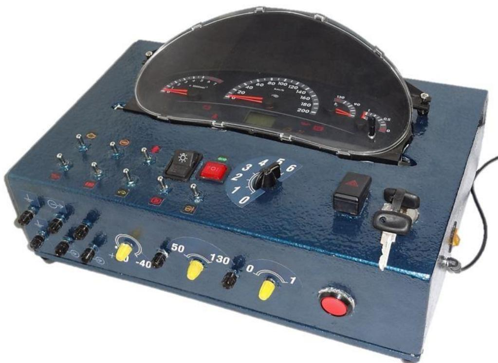
Рис. 1 – Стенд-тренажёр «Информационно-измерительная система автомобиля»
