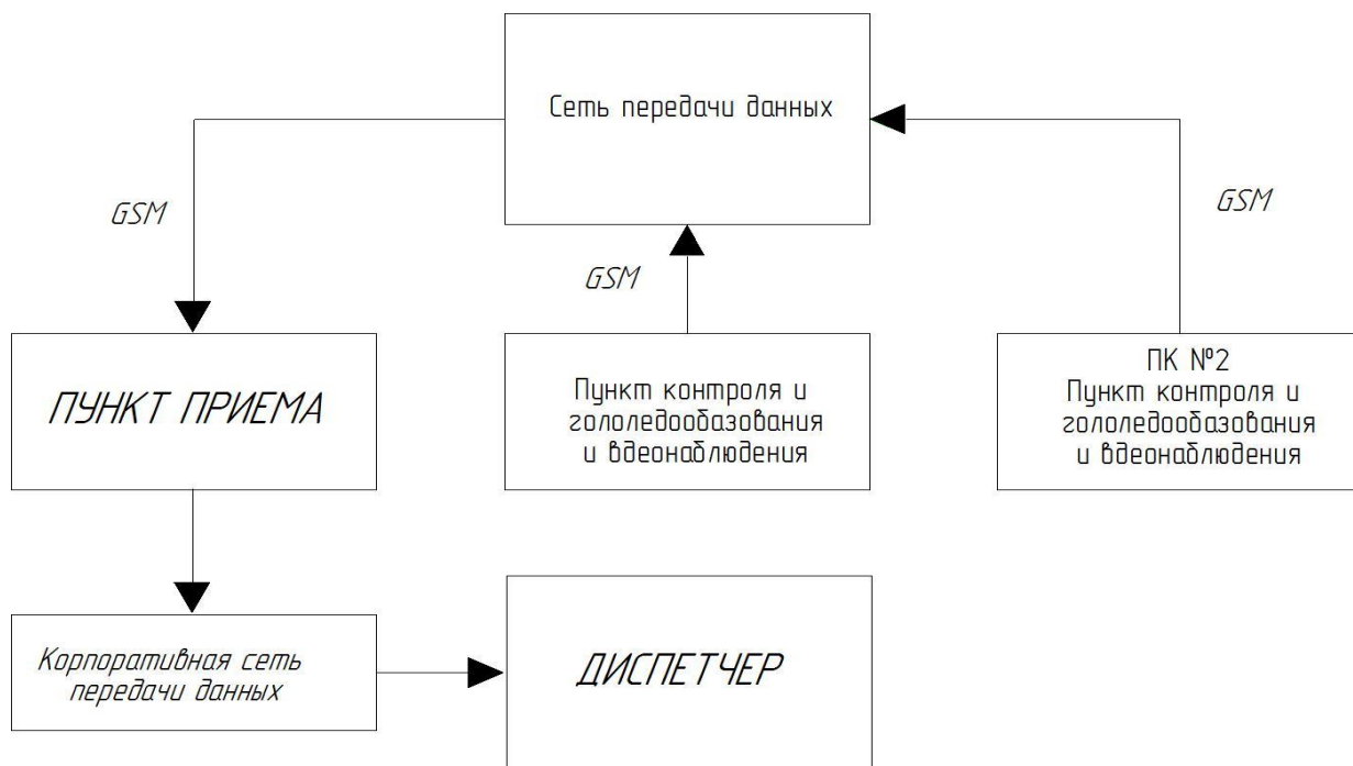
Рисунок 1 – Структурная схема автоматизированной системы контроля гололедной нагрузки.
