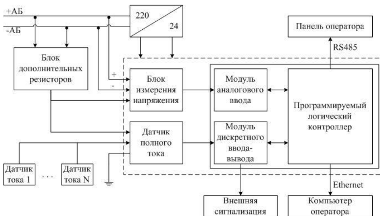
Рисунок 3 – Предлагаемая структурная схема модернизируемой системы контроля изоляции
