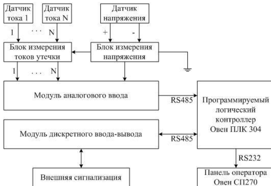
Рисунок 2 – Структурная схема системы контроля изоляции
