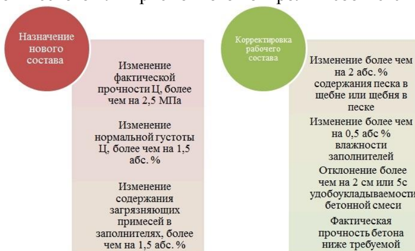
Рис.2 Условия назначения нового состава или корректировки рабочего состава бетона.
