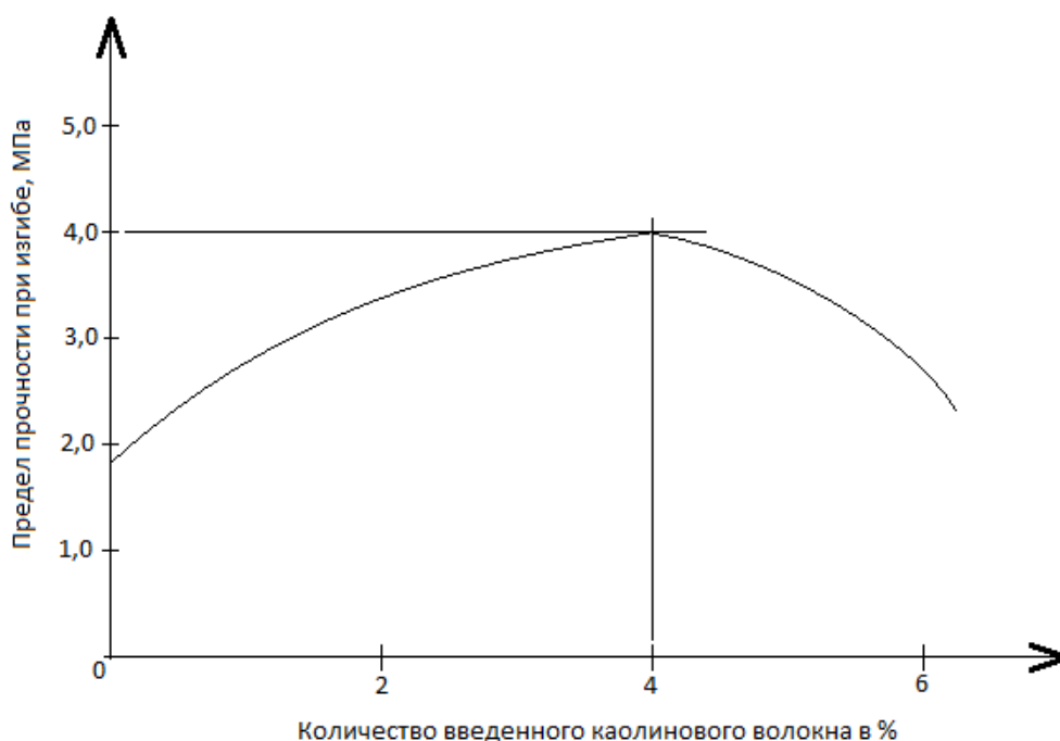
Рисунок 1. Изменение прочности при изгибе жаростойкого бетона на портландцементе в зависимости от введенного каолинового волокна.
