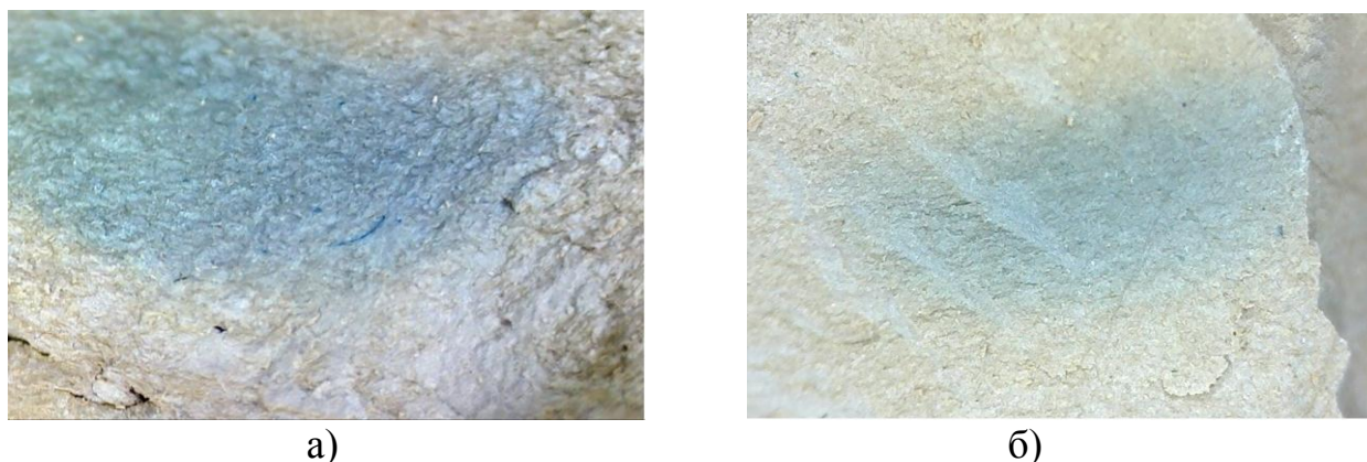
Рис. 1. Изображение излома образца, обожженного при 500°C 3ч., а) – без использования СВЧ-излучения, б) – с использованием СВЧ-излучения.
