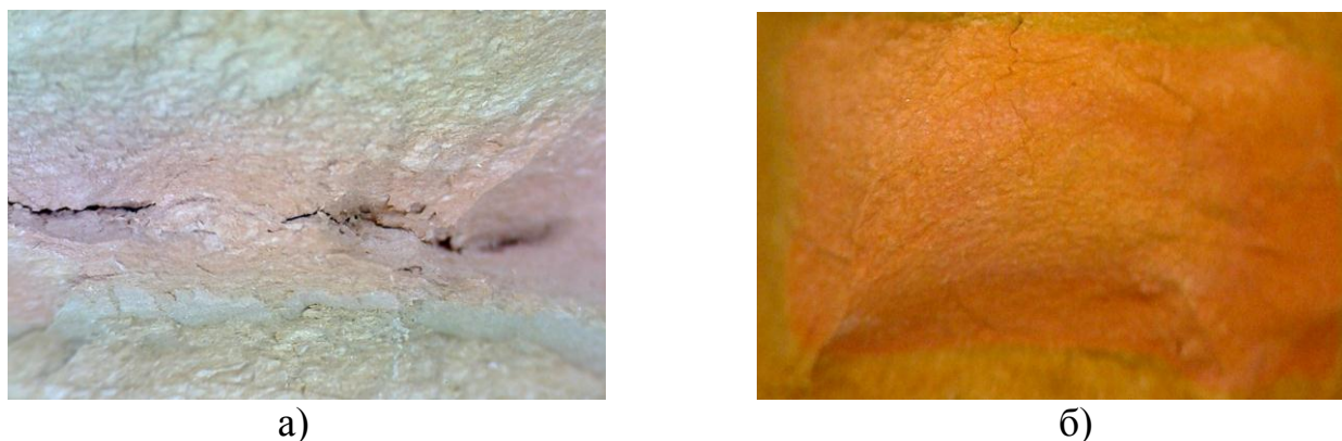
Рис.2. Изображение излома образца, обожженного при 700°C 3ч., а) – без использования СВЧ-излучения, б) – с использованием СВЧ-излучения.
