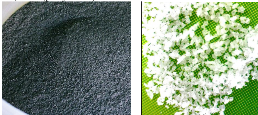
Рисунок 2 – Глиняный порошок и полиэтиленовые микрогранулы (не в масштабе)
