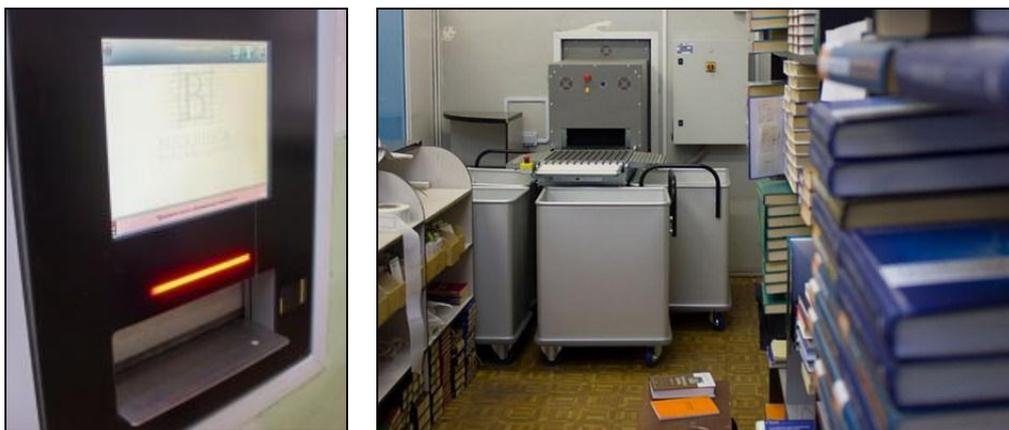
Рисунок 2 – Вид «робота – приемщика» книг (вид спереди и вид сзади)
